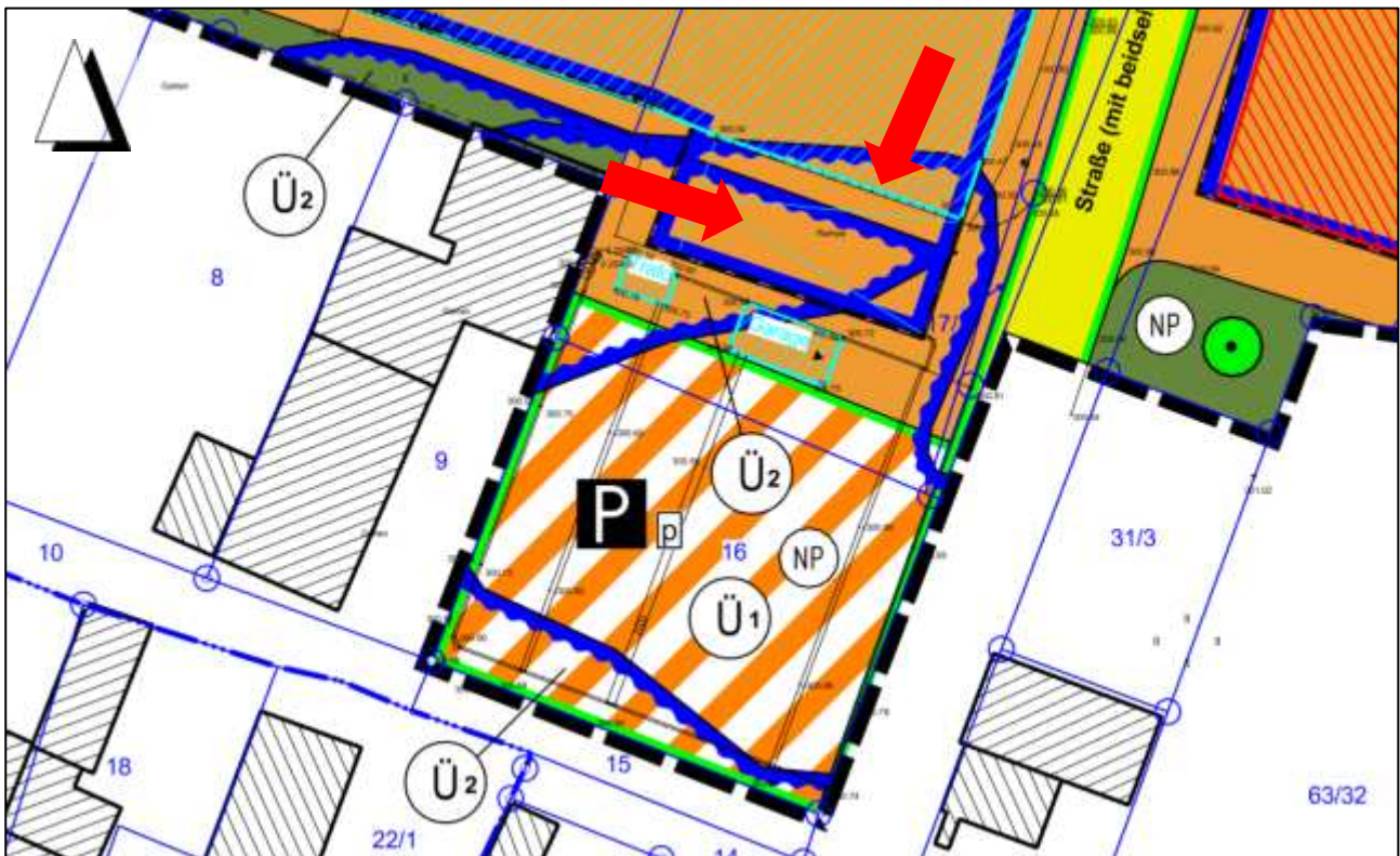
Abbildung 12.2: von Überschwemmungsgebieten betroffene Rampe und Teilbereich des Einkaufszentrums (rote Pfeile; Quelle: Ausschnitt aus Bebauungsplan)
