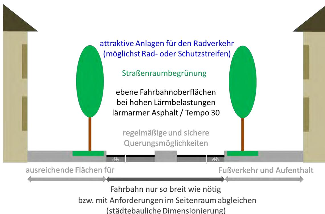
**Abb. 24** idealtypischer Straßenquerschnitt im Sinne der Lärmreduzierung
